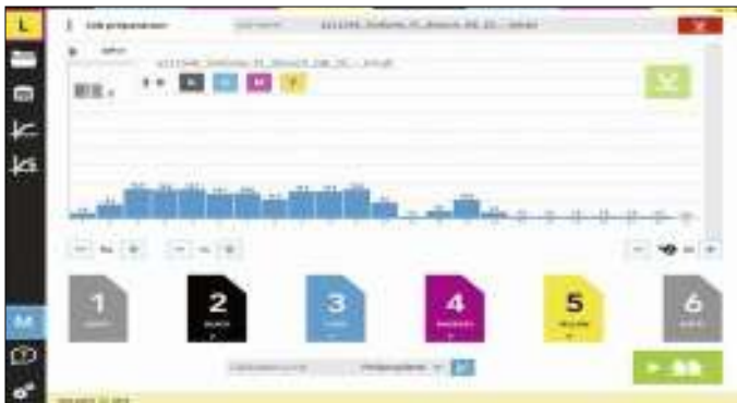
Los trabajos de los flujos de trabajo de preimpresión llegan a través de IZ Plot a IZ Perfect. Con arrastrar y soltar, se cargan en la prensa.
