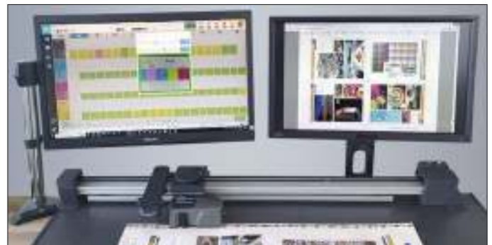
Cliente IZ Plot: La combinación IZ-Plot Server/Client lleva los datos del trabajo a la máquina de impresión y permite al impresor realizar pruebas de color en pantalla.
